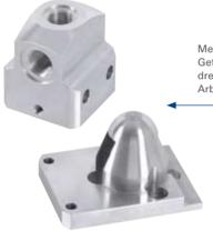
Mechanische Herausforderung: Gefräst, gebohrt, gedreht – dreidimensional in einem Arbeitsgang.
